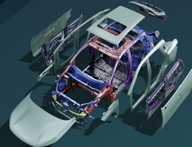
Carrocería Con Acero De Alta Resistencia
